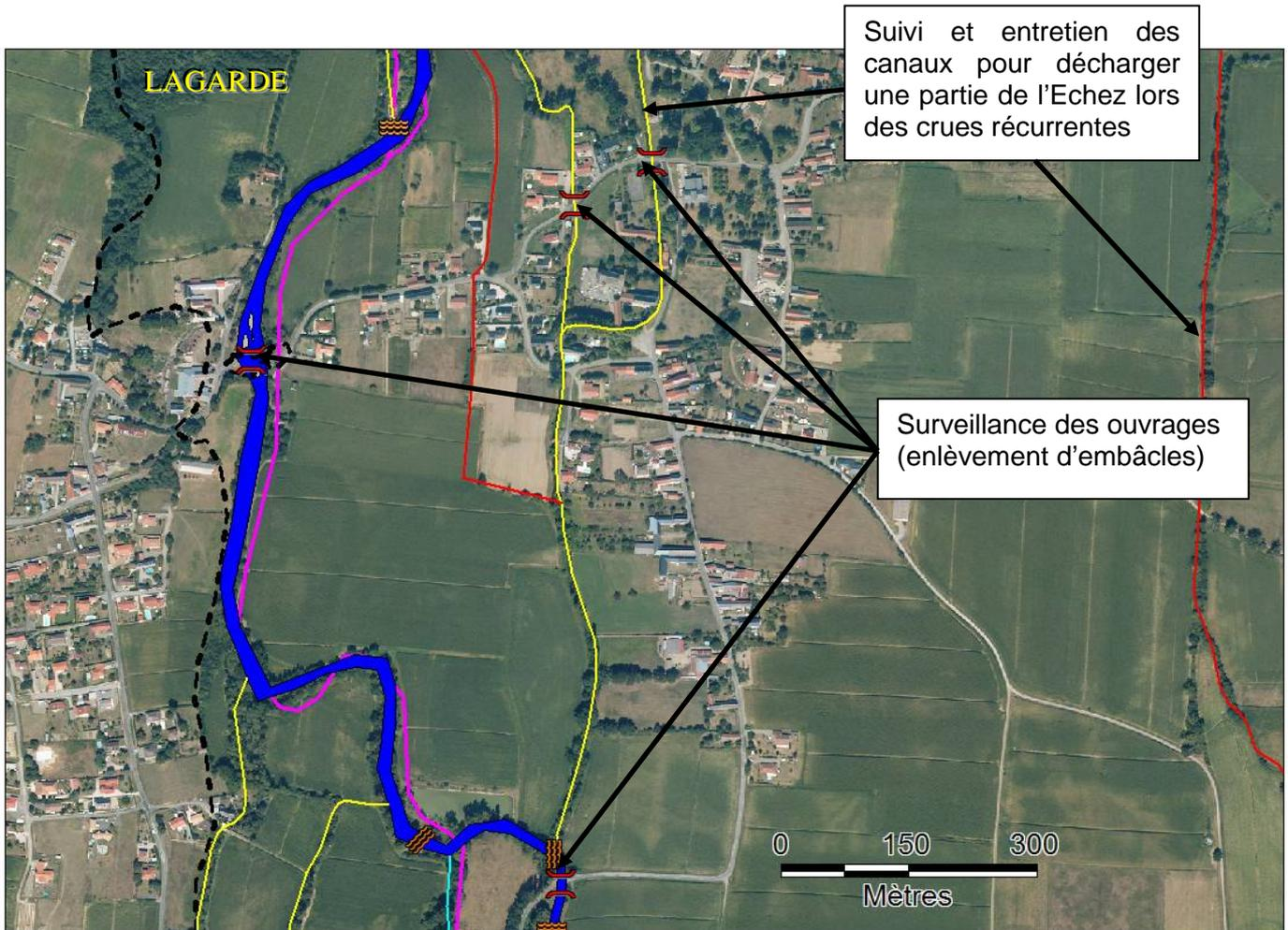
**Nature de l'intervention** : Surveillance des ouvrages et enlèvement d'embâcles si nécessaire. Restauration et entretien de la végétation dans le cadre du programme pluriannuel. Entretien des canaux par désengrèvement de la prise d'eau du canal de Gayan (volume estimé de matériaux à régaler  $10\text{m}^3$ ). Entretien des canaux. Ces travaux se feront lors d'un assec naturel des canaux (linéaire de canaux 1100ml pour le canal de Gayan et 4410ml pour le canal de Lascrabères).
