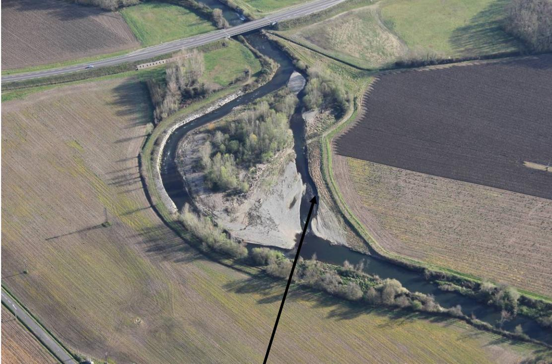
Suivi et accompagnement de la dynamique fluviale pour limiter le risque de déchaussement des enrochements qui protègent le pont de la RD 935;
