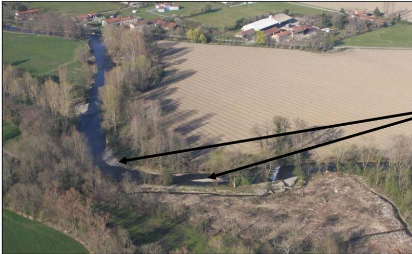
En cas d'érosion importante du chemin situé en rive gauche : déplacement du chemin de quelques mètres et arasement des atterrissements et régalinge des matériaux en rive gauche
