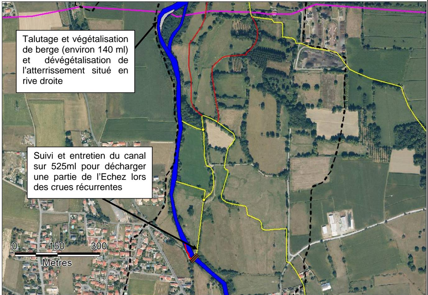
**Nature de l'intervention** : Talutage et végétalisation de la berge de la berge sur 140ml. Dévégétalisation de l'atterrissement en rive droite et entretien du bras secondaire sur 180ml en accompagnement des travaux de talutage. Entretien du canal par désengrèvement de la prise d'eau (volume estimé de matériaux à régaler 10m<sup>3</sup>). La vase sera régagée sur les parcelles avoisinantes.
