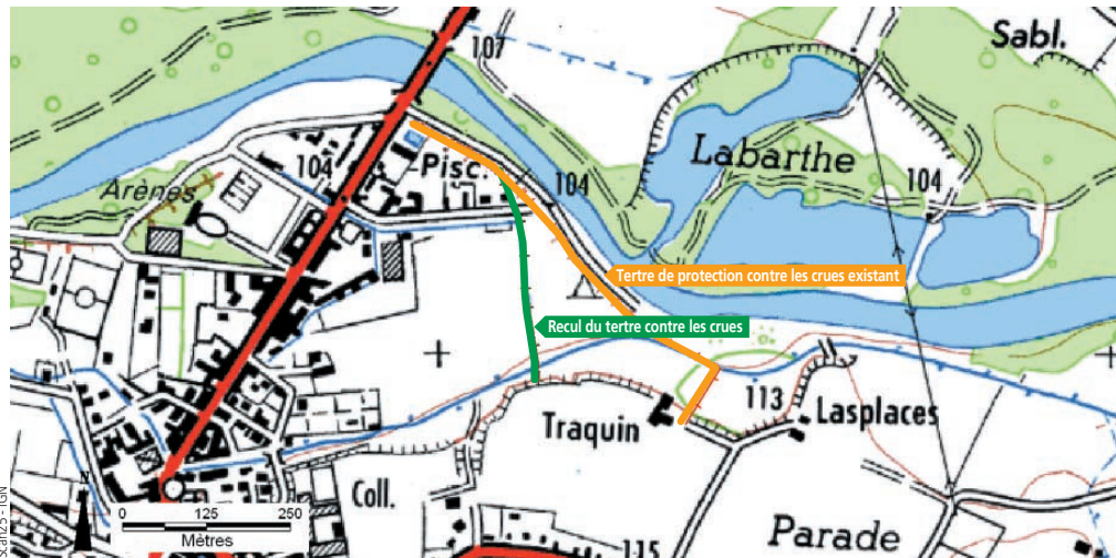
Restauration de trois hectares du lit majeur par le recul de tertres, représentant une aire stockage supplémentaire des eaux de crue de 50 000 m 3
