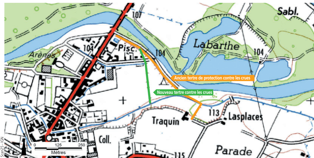
Restauration de trois hectares du lit majeur à Riscle par le recul de tertres, représentant une aire stockage supplémentaire des eaux de crue de 50 000 m 3
